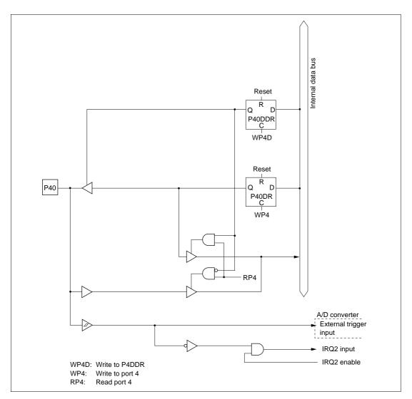
Figure C.10 Port 4 Block Diagram (Pin P40)
