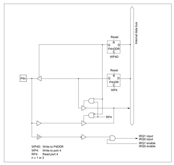
Figure C.11 Port 4 Block Diagram (Pins P41, P42)
