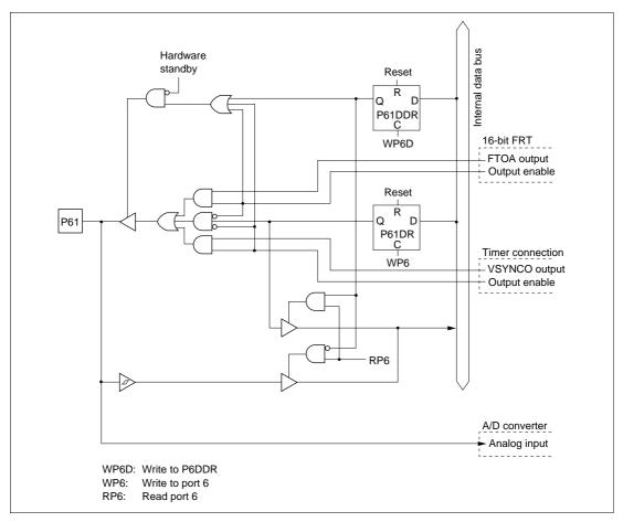
Figure C.19 Port 6 Block Diagram (Pin P61)
