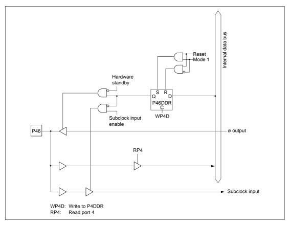
Figure C.13 Port 4 Block Diagram (Pin P46)
